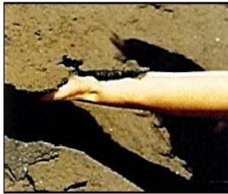
Şekil 4.19: Bir depolama yığınının yüzeyindeki kabuk oluşumu [134, Corus, 1995]
