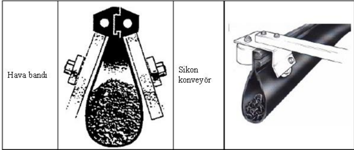
Şekil 3.44: Asılı kayış konveyörlere örnekler [78, DCMR Milieudienst Rijnmond, 1995]
